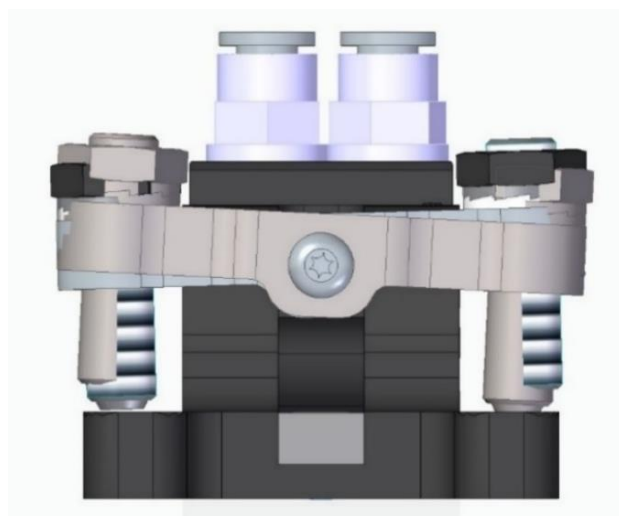
Vue de face d'une pince à bras pivotant
